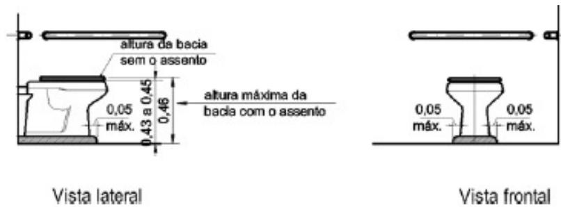
**Figura 121 — Adequação de altura da bacia sanitária com sóculo**
