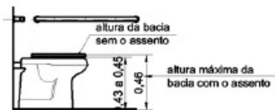
Figura 120 — Adequação de altura da bacia sanitária alongada
