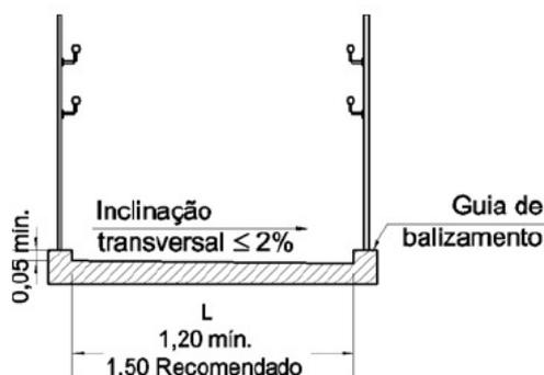
**Figura 80 — Inclinação transversal e largura de rampas - Exemplo**
