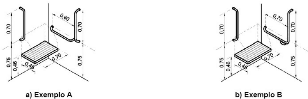
Figura 130 — Perspectiva do boxe com as barras de apoio
