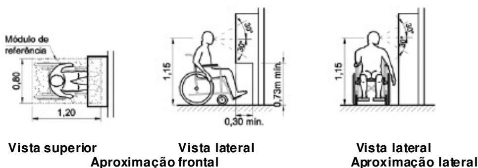
Figura 167 — Máquina de atendimento automático — Exemplo
